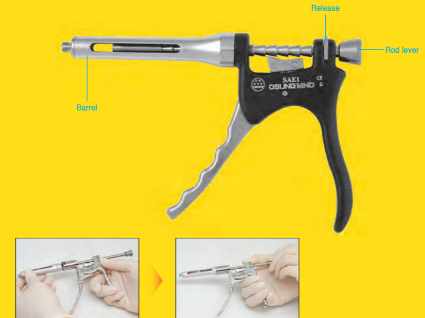
치근막 주사기 사용 전 앰플장착을 위해 Barrel을 홈에 맞춘 후 돌려서 분리 합니다.
